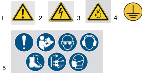
Abb. 1: Sicherheitskennzeichnungen 1 Warnung vor Gefahren | 2 Warnung vor gefährlicher elektrischer Spannung | 3 Warnung vor Einzugsgefahr 4 Erdungssymbol | 5 Sicherheitsgebote
