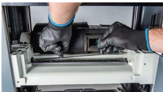
Abb. 25: Messerwechsel mit Hilfe der Magnete
