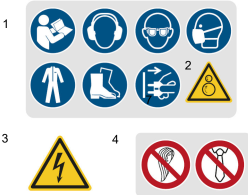
Abb. 1: Sicherheitskennzeichnungen: 1 Gebotszeichen (Gebrauchsanweisung beachten / Gehörschutz tragen / Augenschutz tragen / Maske benutzen / Schutzkleidung benutzen / Sicherheitsschuhe tragen / Netzstecker ziehen) | 2 Warnzeichen ( 2 Warnung vor Einzugsgefahr / 3 Warnung vor gefährlicher, elektrischer Spannung) | 4 Verbotsschilder (Bedienung mit langen Haaren verboten / Bedienung mit Krawatte verboten)
