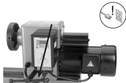
Abb. 18: Positionieren des Spindelstocks
