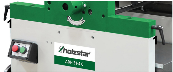
Abb. 8: Umbau zur Dickenhobelfunktion
