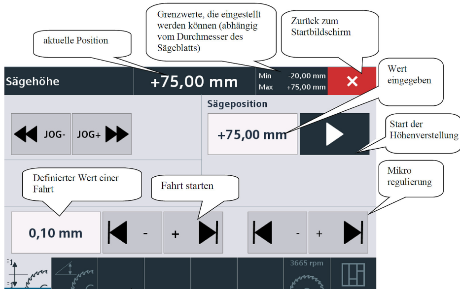
Abb. 6-9: Höhenverstellung Sägeblatt FKS 550-3200 M A 3 UP TOP
