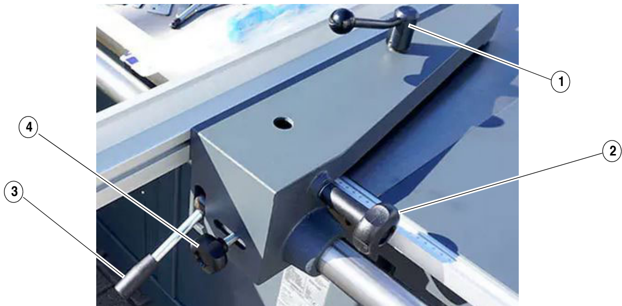
Abb.6-11: Einstellung des Queranschlags FKS 350-3200 PRO, FKS 550-3200 PRO, FKS 400-3200 M A PRO und FKS 550-3200 M A PRO
