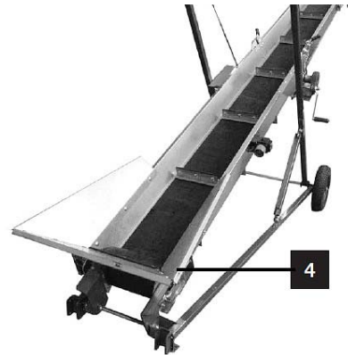
Abb. 11: Montage des Einfülltrichter
