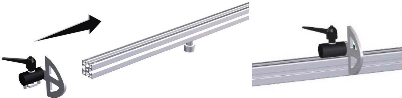
Abb.5-7: Montage des beweglichen Anschlags
