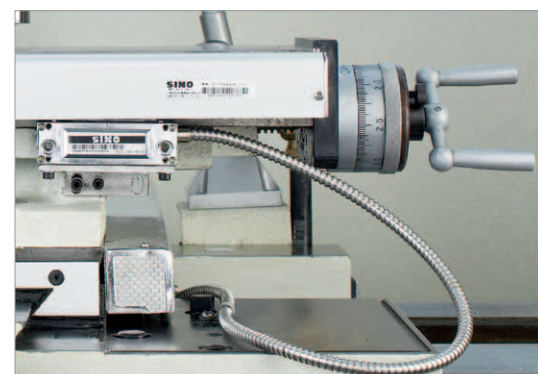
Oberschlitten mit Ableseeinheit auf einer Universal Drehmaschine
