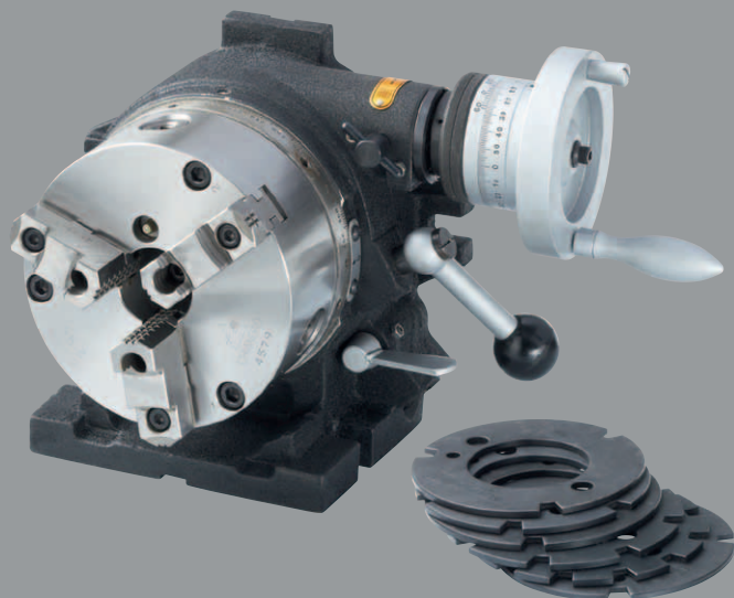
Teilapparat TAHV mit Dreibackens-Drehfutter und sechs präzisen Einrastzscheiben für die Teilungen 2 x 180°, 3 x 120°, 4 x 90°, 6 x 60°, 8 x 45°, 12 x 30° und 24 x 15°
