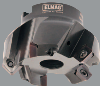
Planfräser 45°, Ø 63 mm, 6 Schneiden, Aufnahme 22 mm
