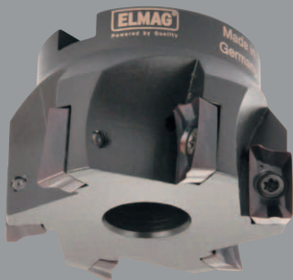
Eckfräser 90°, Ø 63 mm, 6 Schneiden, Aufnahme 22 mm
