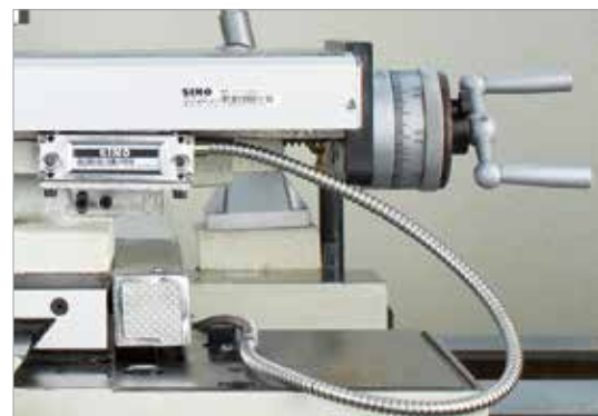
Oberschlitten mit Ableseeinheit auf einer Universaldrehmaschine
