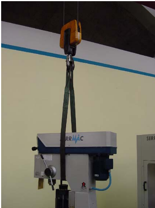
Abbildung 1 Anheben und Transport der Maschine.
