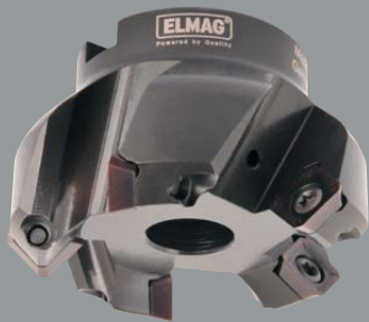
Planfräser 45°, Ø 63 mm, 6 Schneiden, Aufnahme 22 mm
