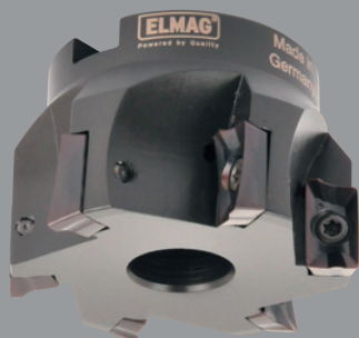
Eckfräser 90°, Ø 63 mm, 6 Schneiden, Aufnahme 22 mm
