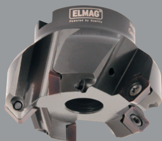
Planfräser 45°, Ø 63 mm 6 Schneiden, Aufnahme 22 mm
