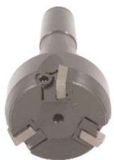
Planfräser Ø 47 mm für Morsekonus MK 3 bzw. Anzugsspindel M10
