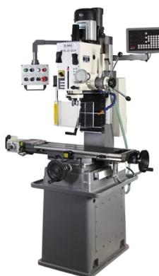
**Getriebe Fräs- und Bohrmaschine MFB 45 GLH inkl. 3-Achs digitale Positionsanzeige 'SINO'**
